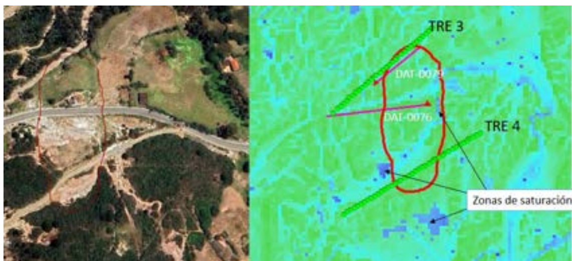
Figura 14 Correlación entre los ensayos realizados e Índice topográfico de humedad. Fuente: SGR 2023.
