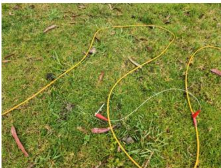
Levantamiento del ensayo de resistividad eléctrica
