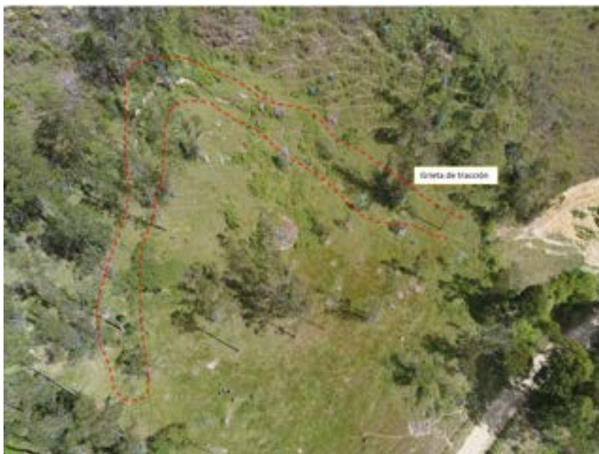
Figura 5. Grieta de deslizamiento Manu. Fuente: SGR, 2023
