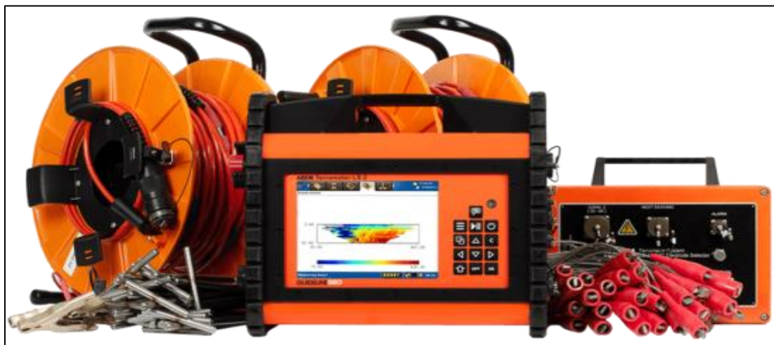
Figura 3. Equipo utilizado, Terrameter Ls2, marca ABEM. Fuente: (Grupo Sandox, 2023)..
